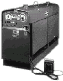
Grupo de soldadura
