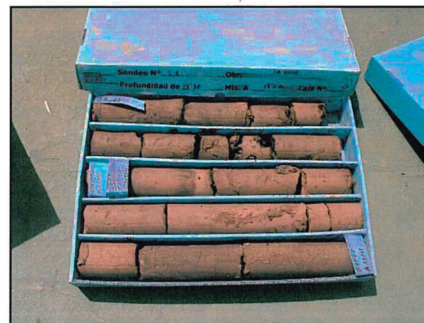
Foto 4. Vista de sondeo n° 1, de 13,30 a 18,00 metros de profundidad. Caja 4 de 4.
