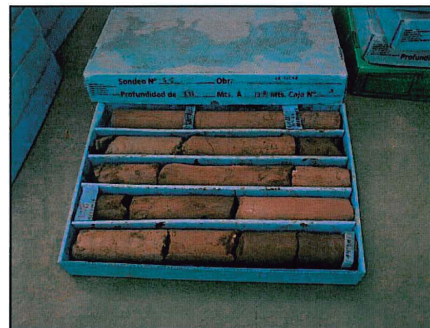
Foto 7. Vista de sondeo n° 2, de 8,50 a 14,50 metros de profundidad. Caja 3 de 4.
