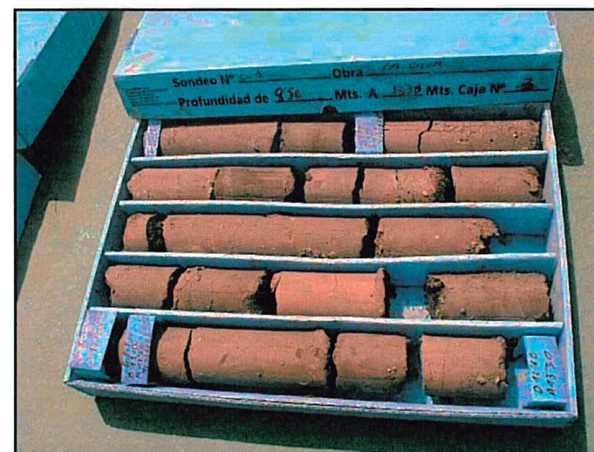
Foto 3. Vista de sondeo n° 1, de 8,50 a 13,30 metros de profundidad. Caja 3 de 4.
