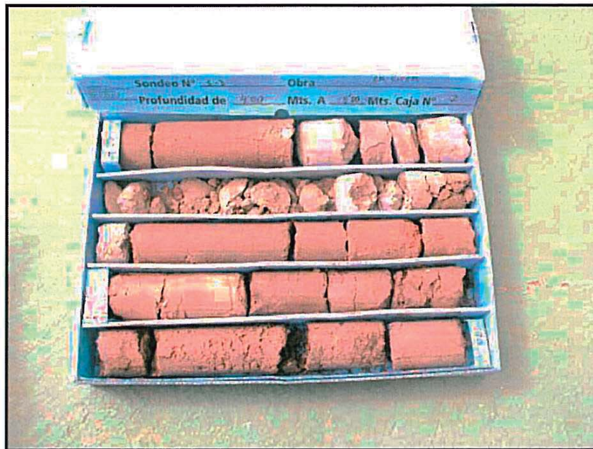
Foto 10. Vista de sondeo n° 3, de 4,00 a 8,00 metros de profundidad. Caja 2 de 4.
