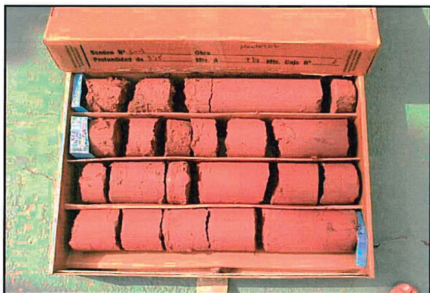
Foto 2. Vista de sondeo n° 1, de 3,15 a 7,00 metros de profundidad. Caja 2 de 3.
