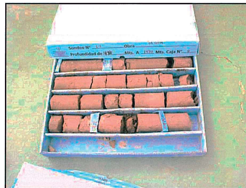
Foto 8. Vista de sondeo n° 2, de 14,50 a 19,00 metros de profundidad. Caja 4 de 4.
