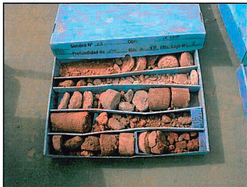
Foto 5. Vista de sondeo n° 2, de 0,00 a 4,50 metros de profundidad. Caja 1 de 4.
