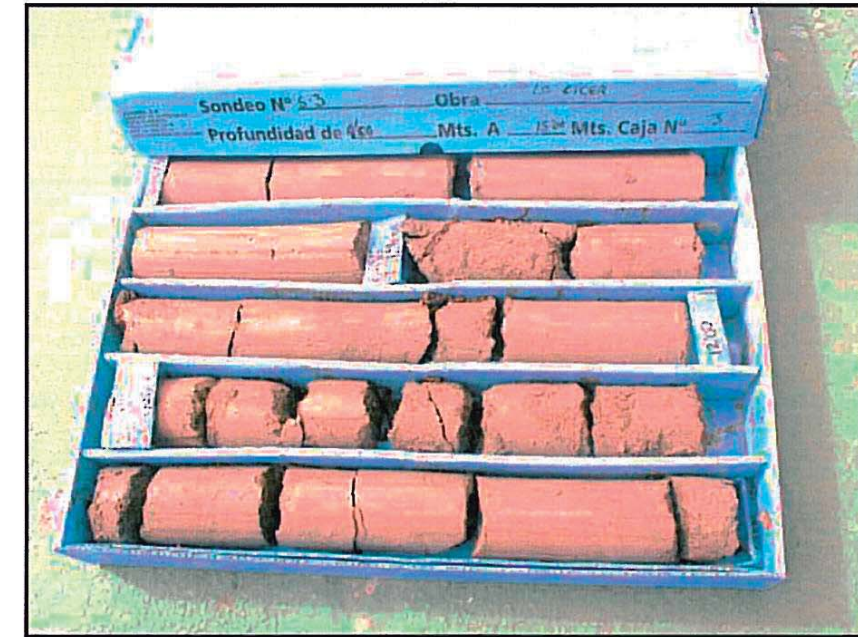
Foto 11. Vista de sondeo n° 3, de 8,00 a 15,00 metros de profundidad. Caja 3 de 4.
