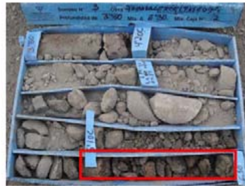
Ensayos Sondaje 3, profundidad de 5,80 a 6,30 m
