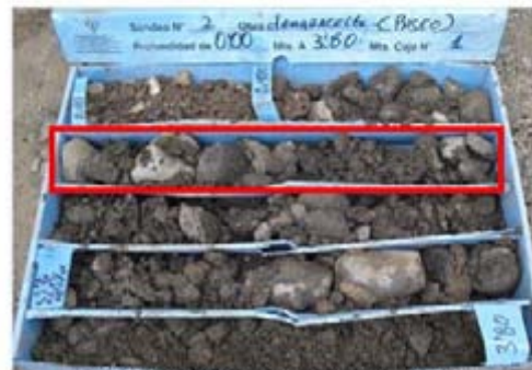
Ensayos Sondaje 2 profundidad 0,60 a 1,20 m
