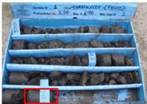
Ensayo sondaje 1, profundidad de 5,80 a 6,00.
