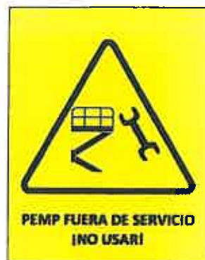
Figura 24. Señal de PEMP fuera de servicio.
