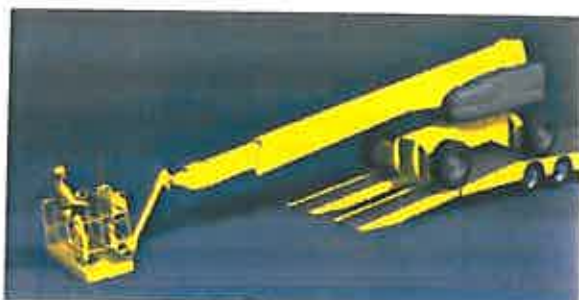
Figura 29. Colisión de la plataforma de trabajo contra el suelo.
