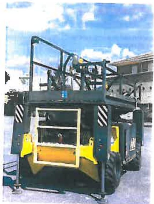
Figura 6. Plataforma de trabajo con protecciones perimetrales plegables.
