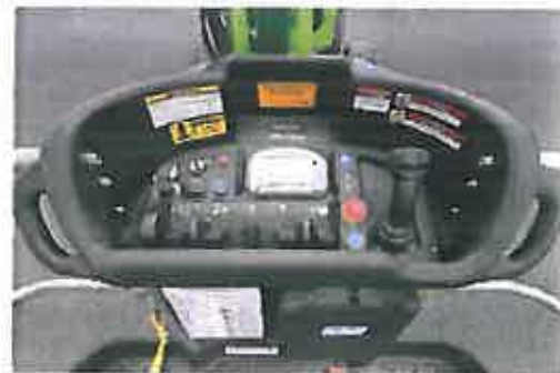
Figura 10. Mando primario sobre plataforma de trabajo.
