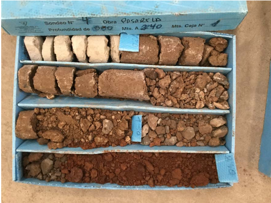
Foto 21: Sondeo 4 de 0,00 a 2,40 m
