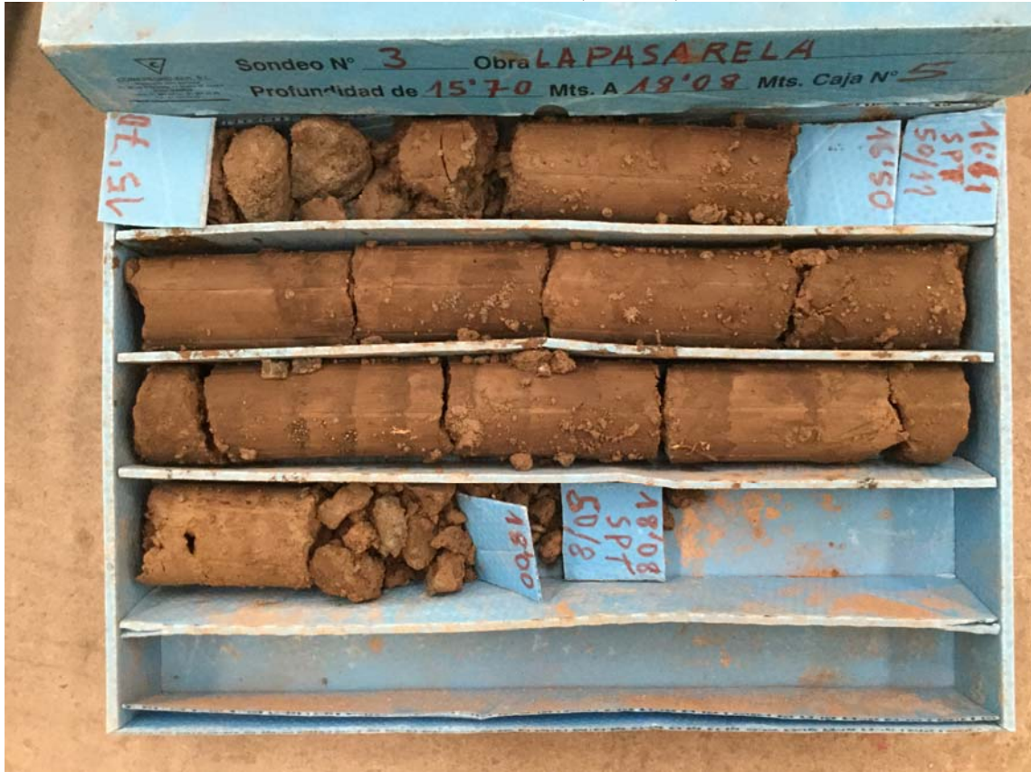
Foto 19: Sondeo 3 de 15,70 a 18,00 m
