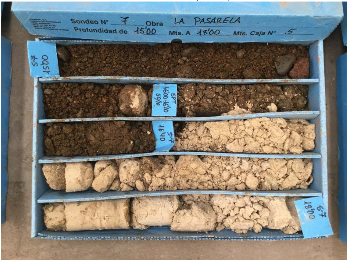
Foto 38: Sondeo 7 de 15,00 a 18,00 m
