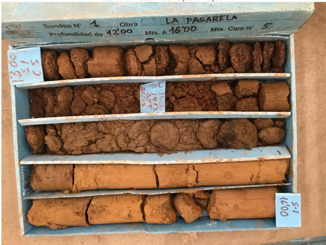
Foto 6: Sondeo 1 de 13,00 a 16,00 m
