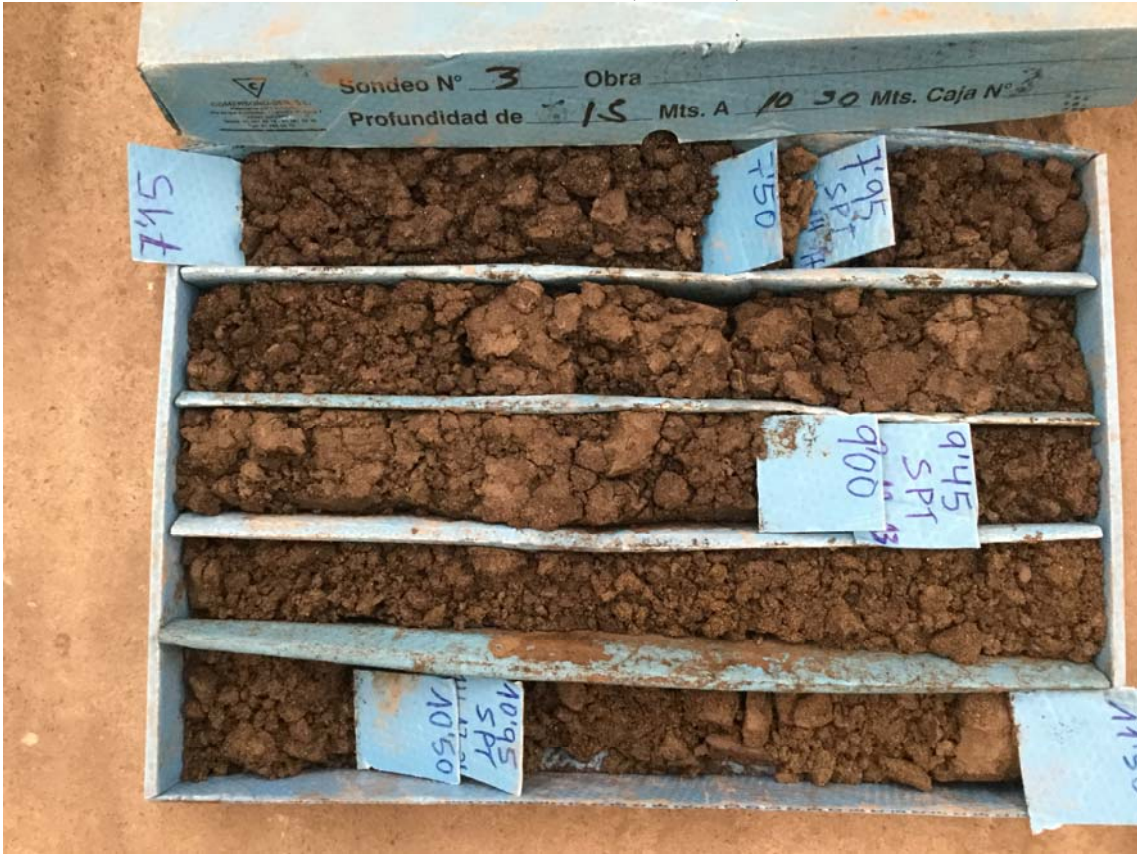
Foto 17: Sondeo 3 de 7,15 a 11,50 m
