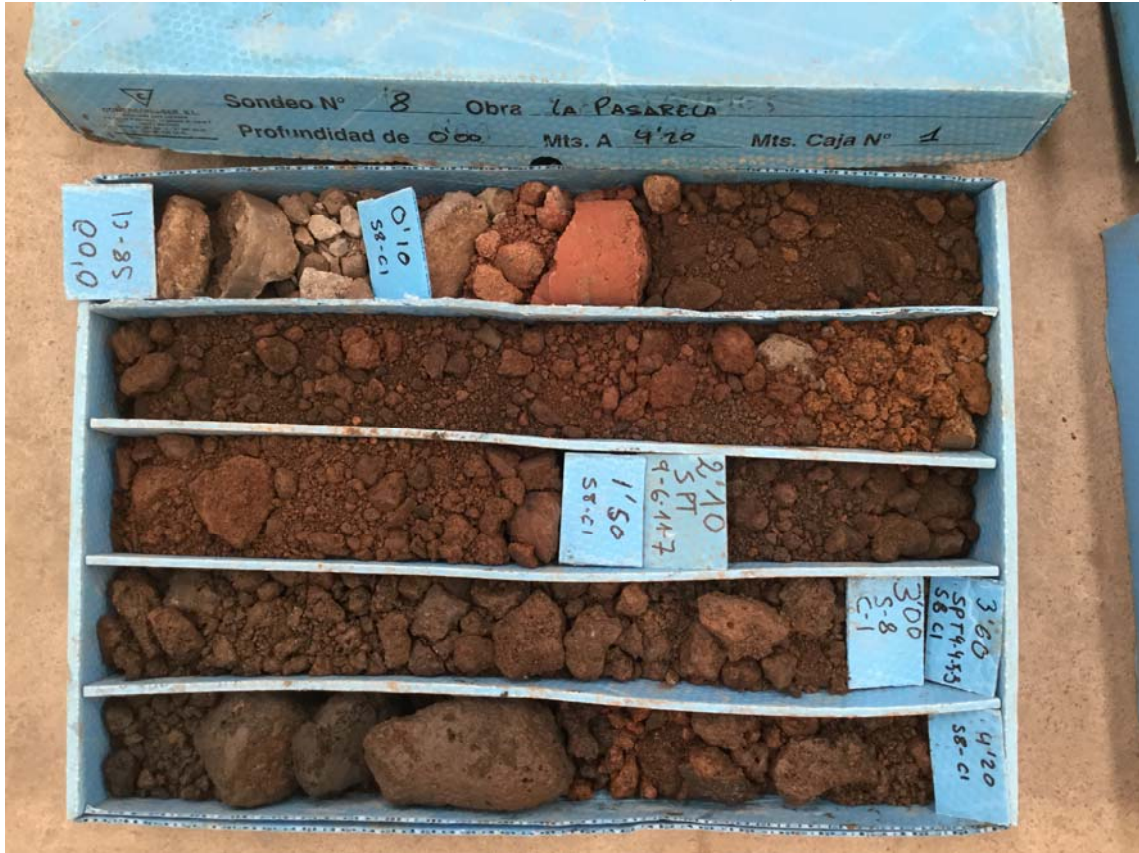
Foto 41: Sondeo 8 de 0,00 a 4,20 m
