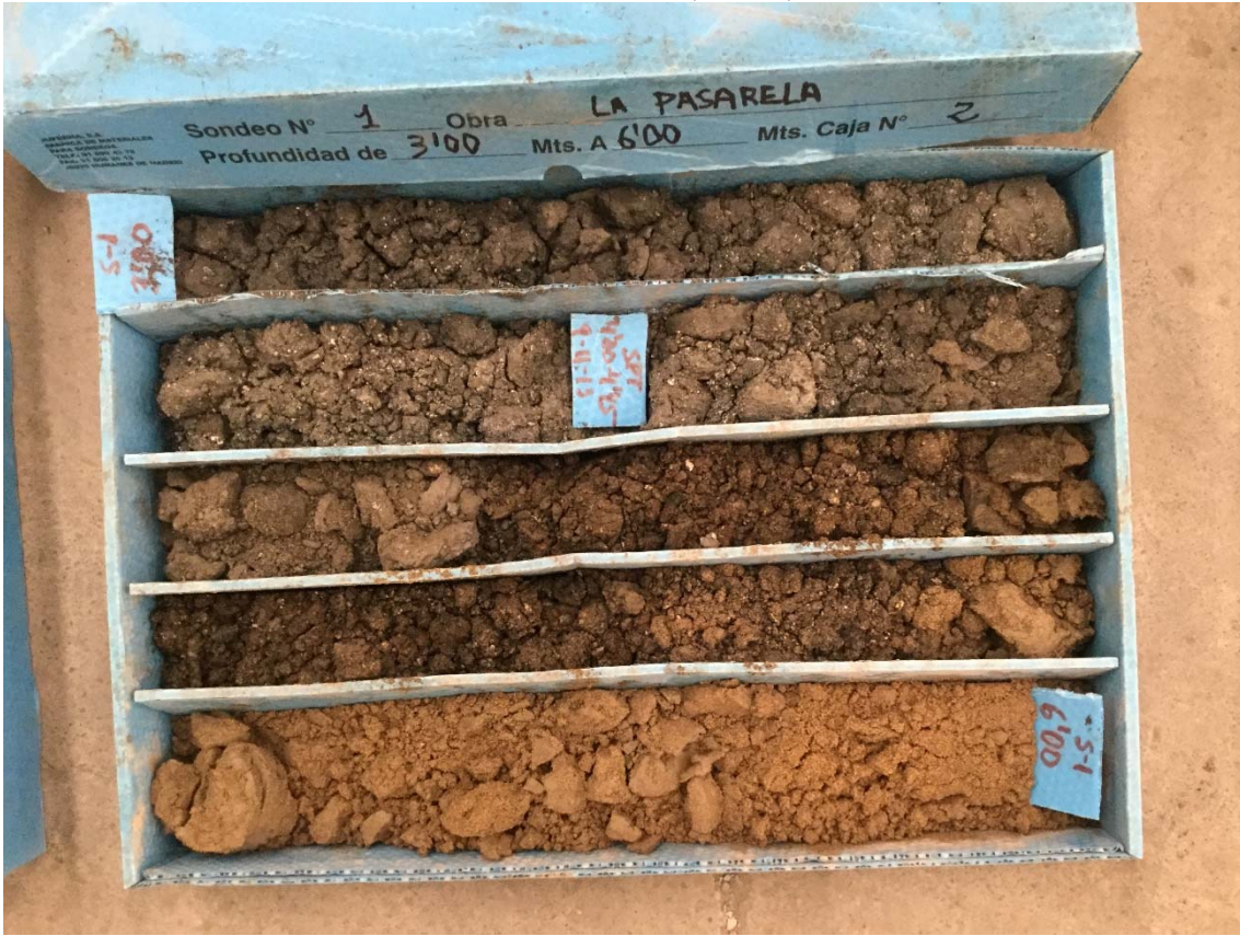
Foto 3: Sondeo 1 de 3,00 a 6,00 m
