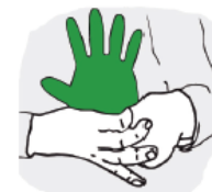
Figura 4. Comprobación de la ausencia de fugas.
