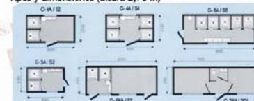
Tipos y dimensiones (altura 2,70 m)
