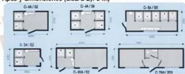
Tipos y dimensiones (altura 2,70 m)
