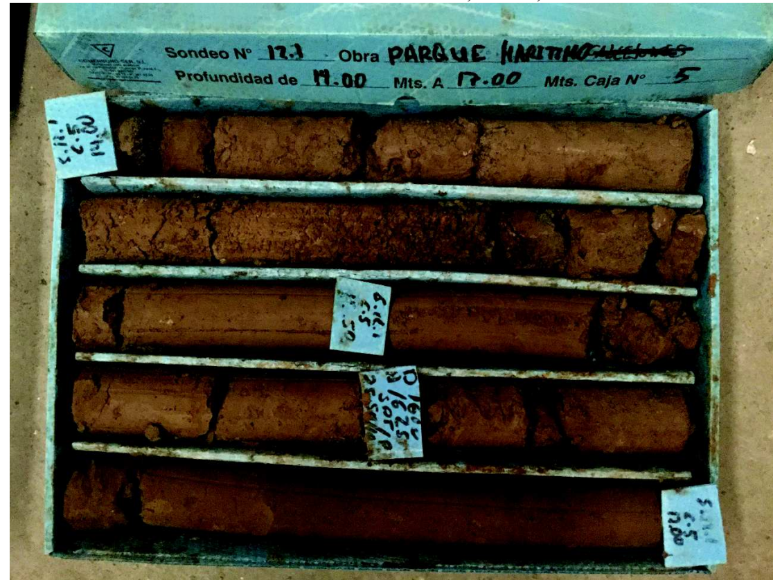
Foto 143: Sondeo 12.1 de 141,00 a 17,00 m
