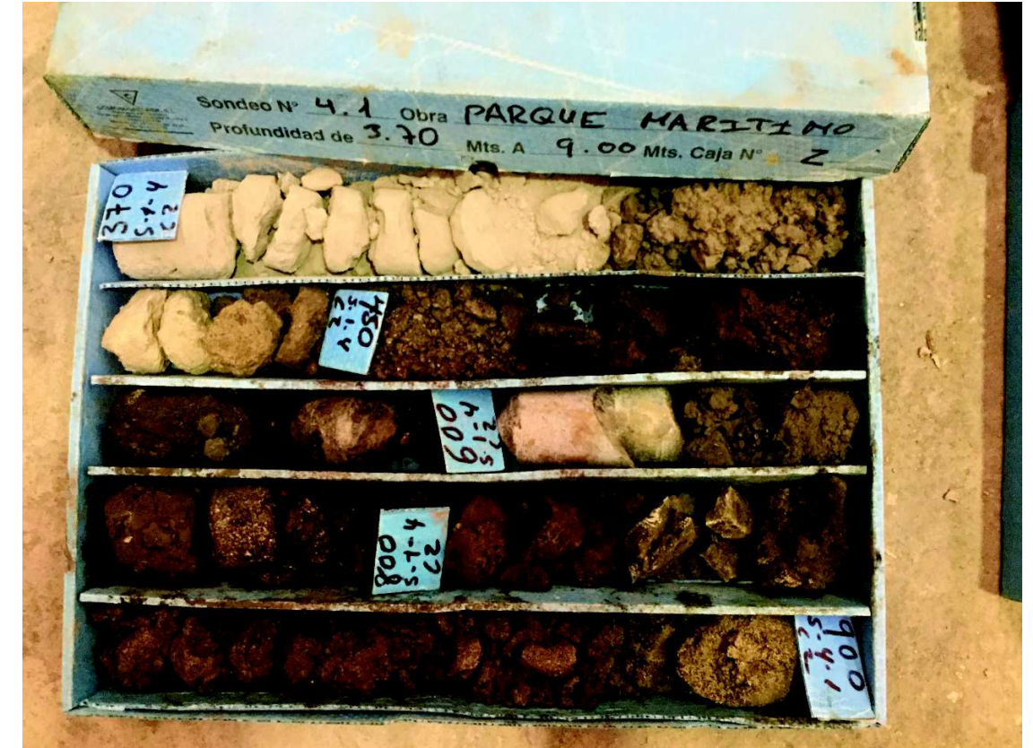
Foto 41: Sondeo 4.1 de 3,70 a 9,00 m
