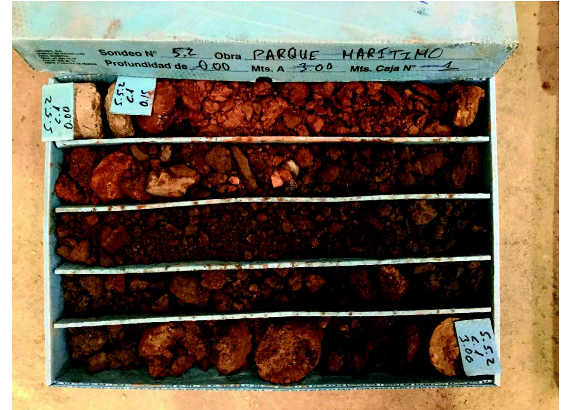
Foto 57: Sondeo 5.2 de 0,00 a 3,00 m
