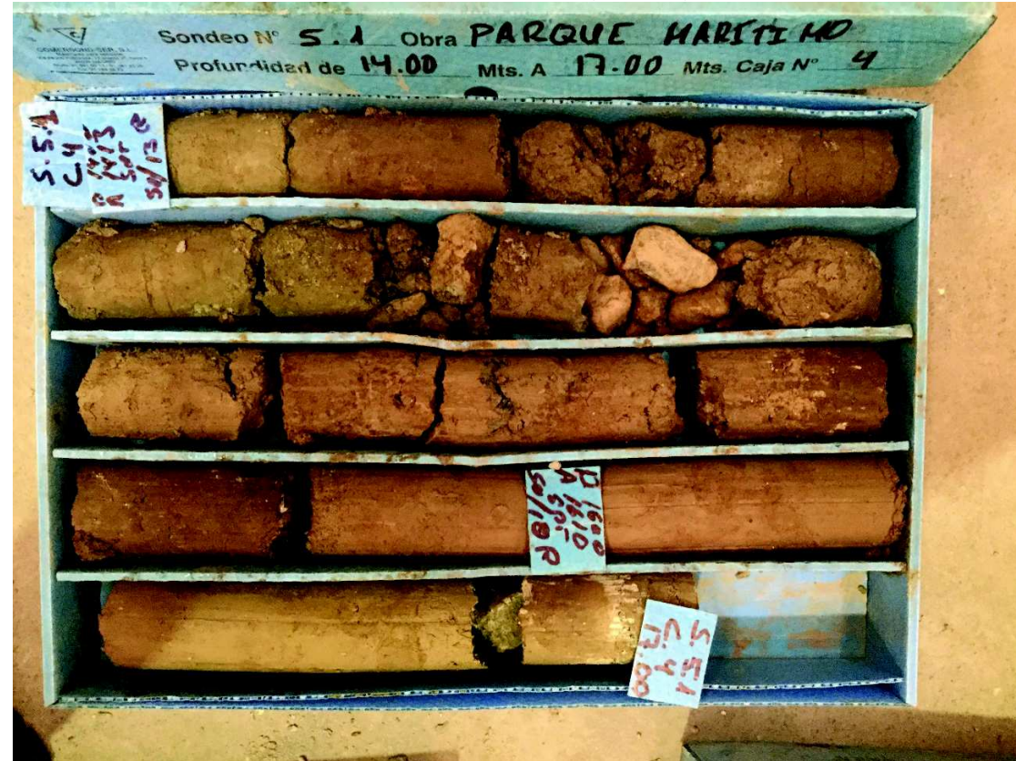
Foto 55: Sondeo 5.1 de 14,00 a 17,00 m
