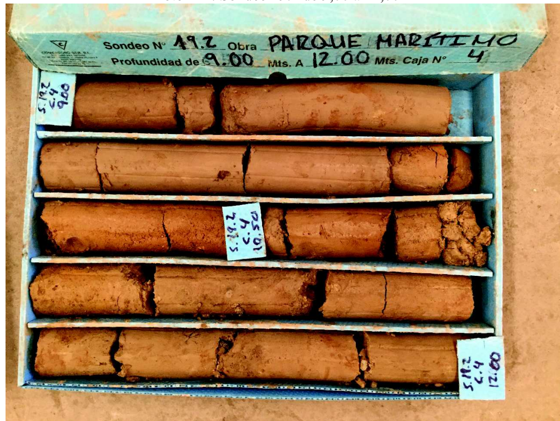
Foto 244: Sondeo 19.2 de 9,00 a 12,00 m
