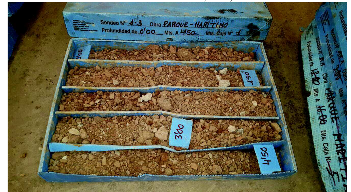
SONDEOS INCLINADOS A 30° Foto 259: Sondeo 1.3 de 0,00 a 4,50 m
