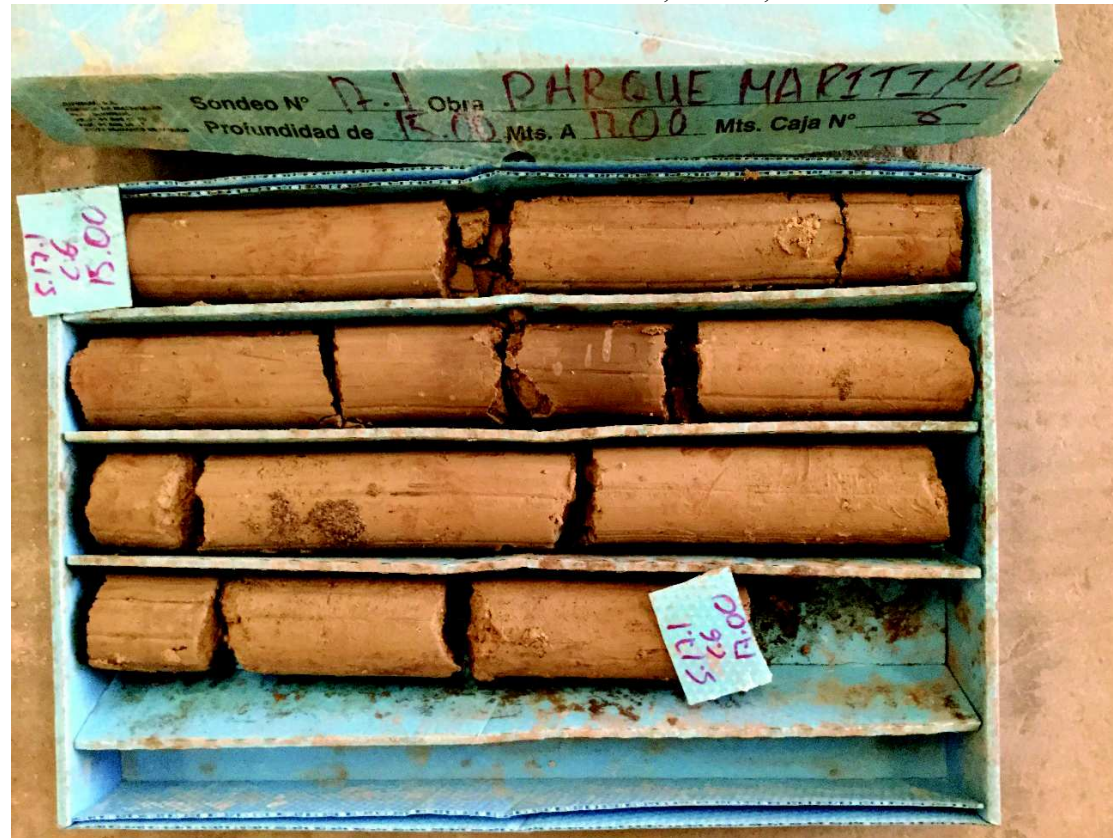
Foto 211: Sondeo 17.1 de 15,00 a 17,00 m
