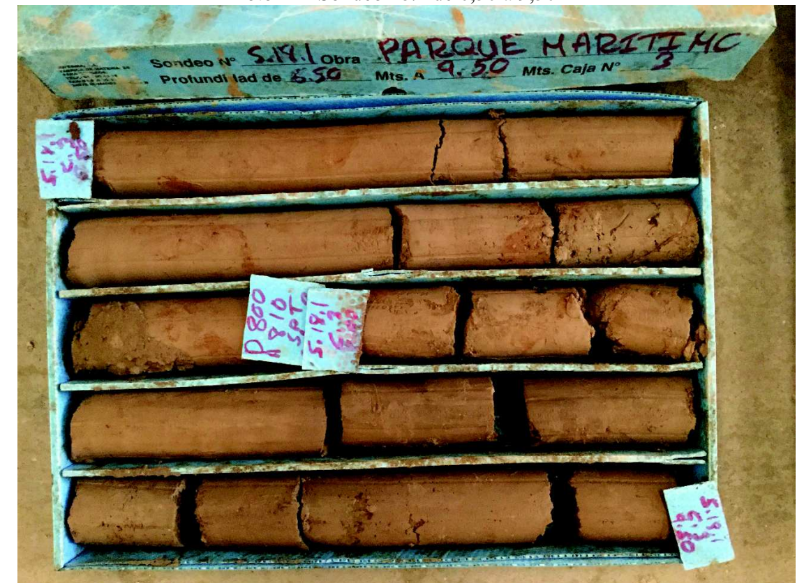
Foto 222 Sondeo 18.1 de 6,50 a 9,50 m
