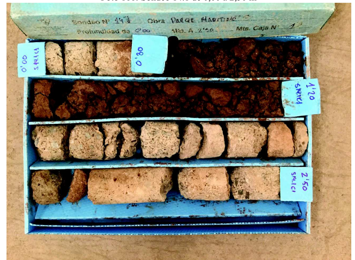
Foto 166: Sondeo 14.1 de 0,00 a 2,50 m
