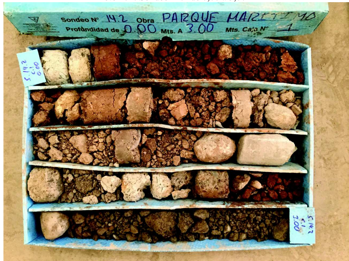
Foto 172: Sondeo 14.2 de 0,00 a 3,00 m
