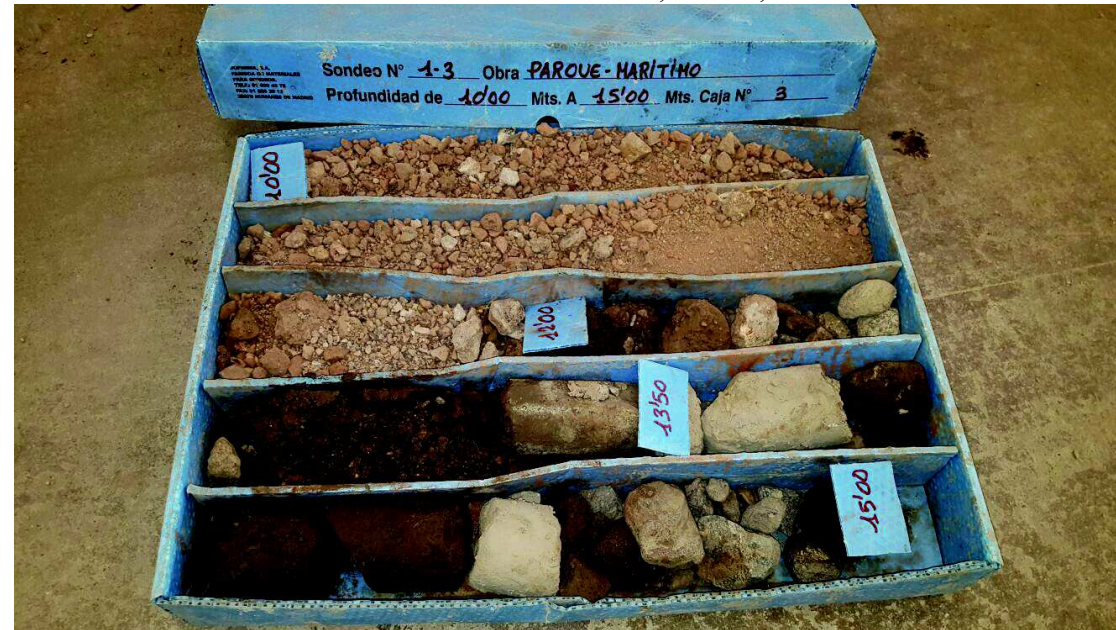
Foto 261: Sondeo 1.3 de 10,00 a 15,00 m
