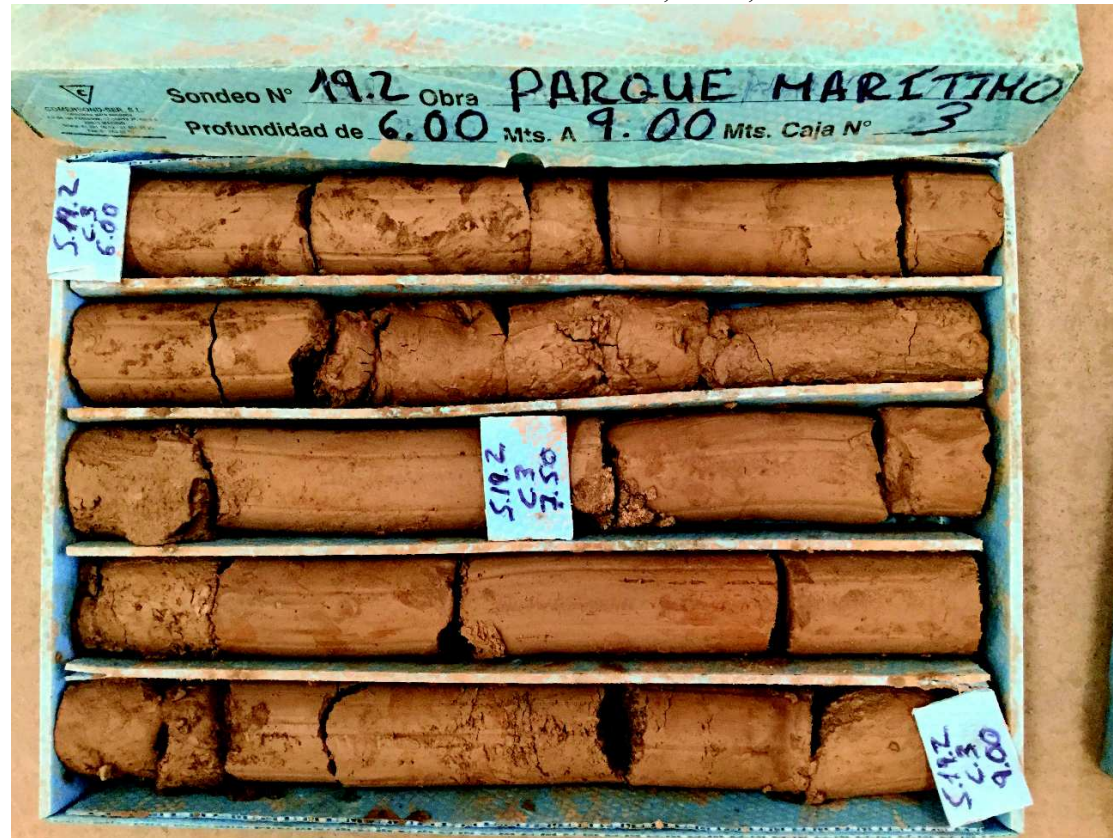
Foto 243: Sondeo 19.2 de 6,00 a 9,00 m
