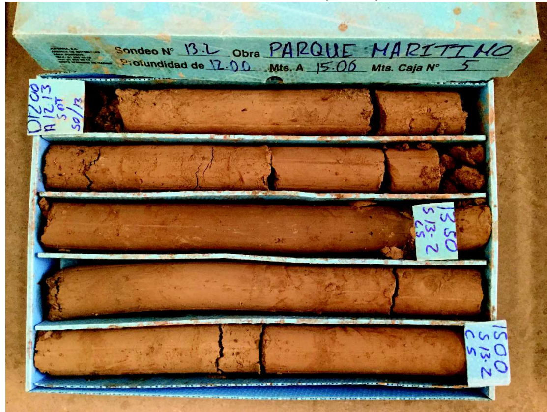
Foto 163: Sondeo 13.2 de 12,00 a 15,00 m
