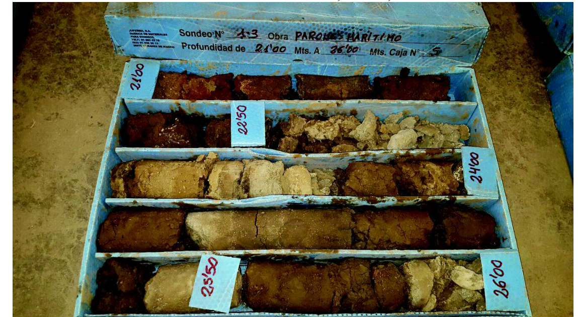
Foto 263: Sondeo 1.3 de 21,00 a 26,00 m
