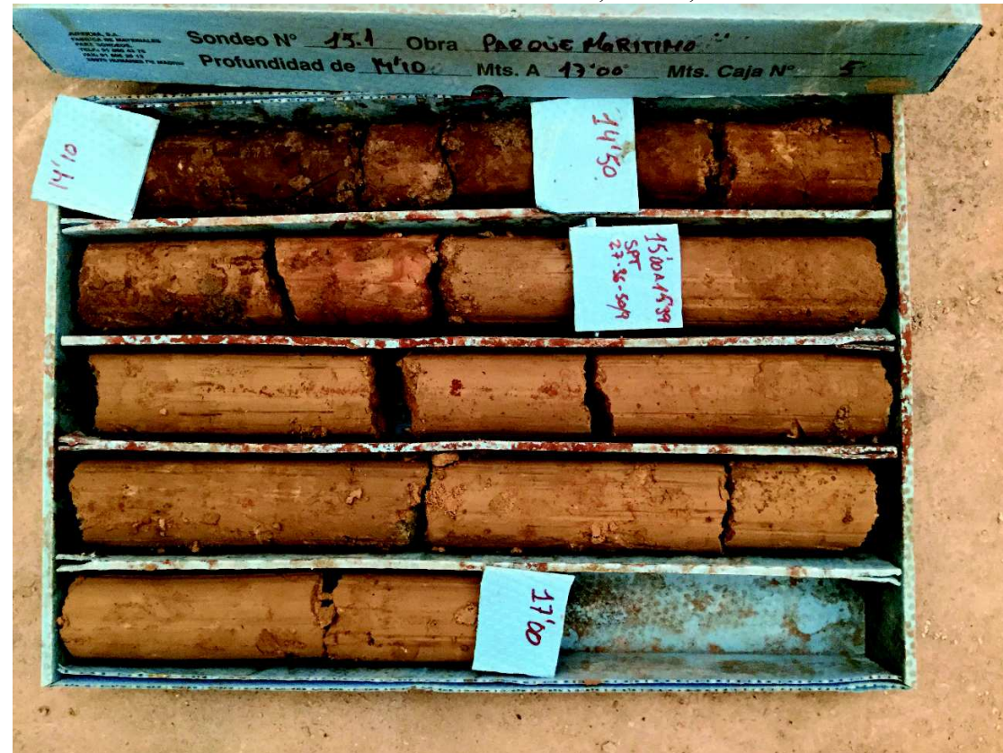
Foto 183: Sondeo 15.1 de 13,50 a 17,00 m
