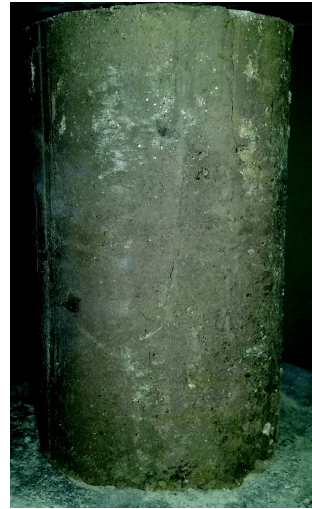
Muestra antes de la rotura
