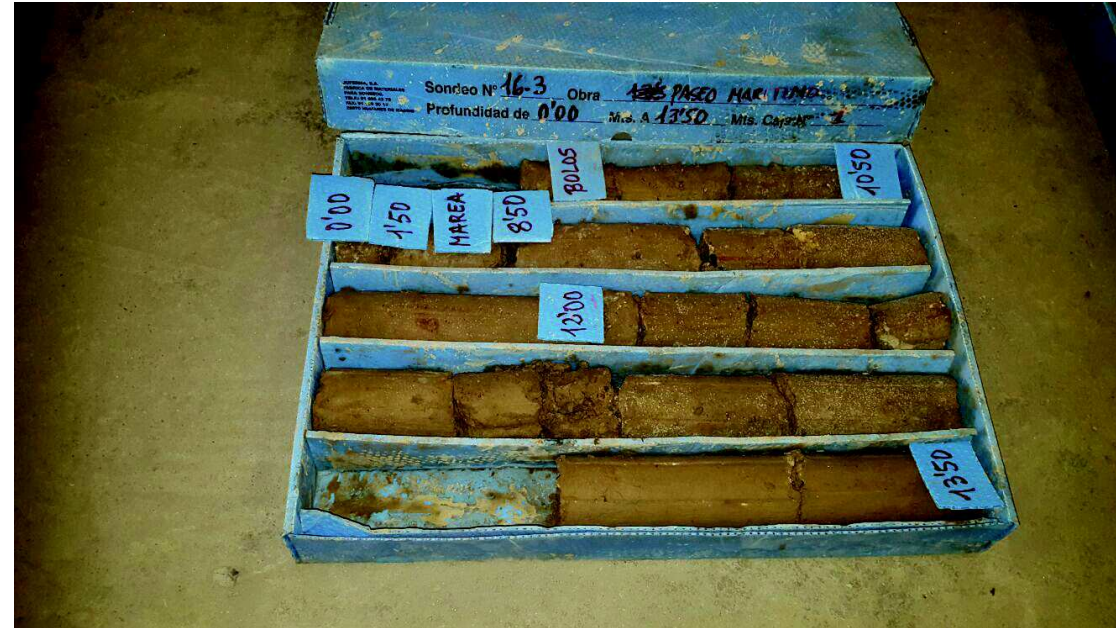
Foto 323: Sondeo 16.3 de 0,00 a 13,50 m
