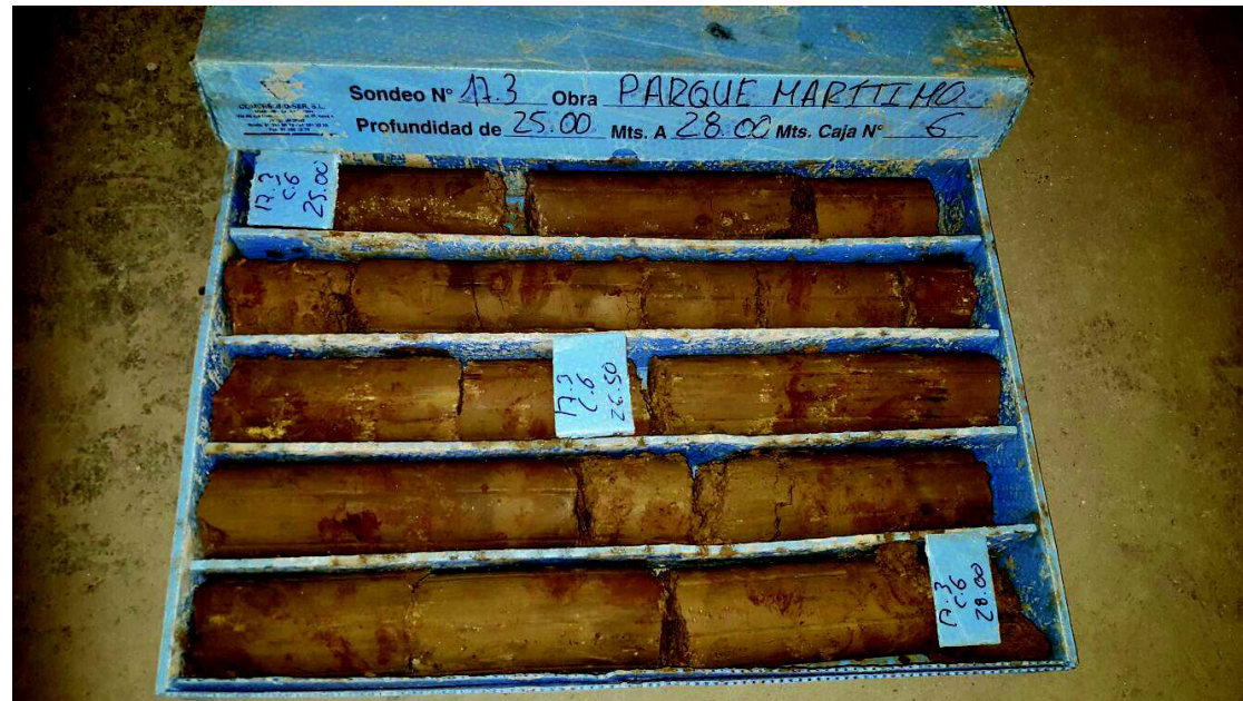
Foto 335: Sondeo 17.3 de 25,00 a 28,00 m
