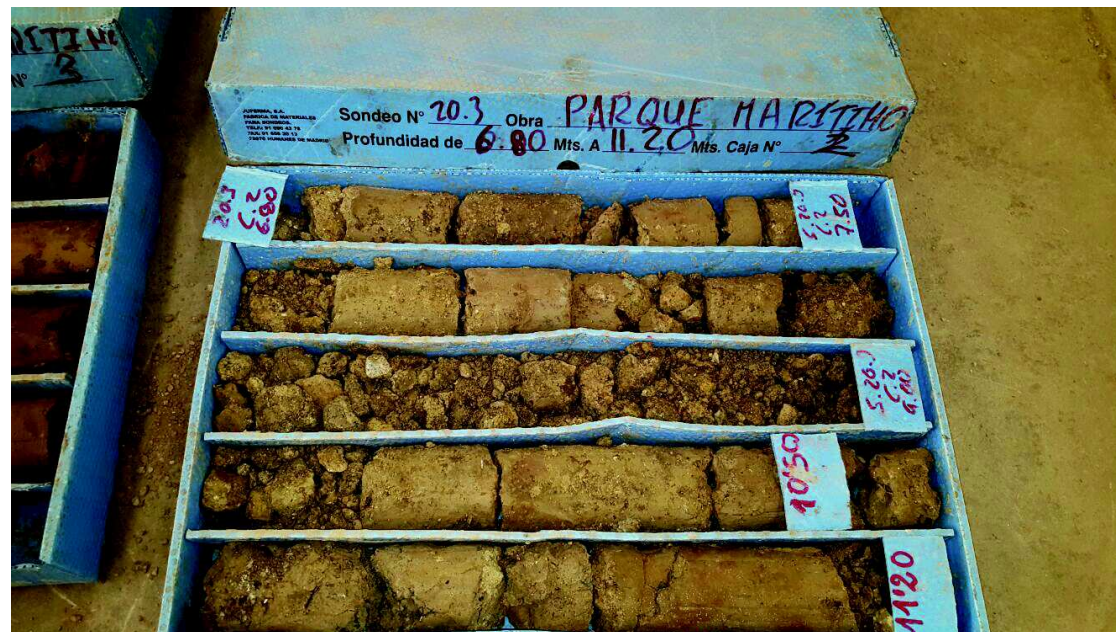
Foto 355: Sondeo 20.3 de 6,80 a 11,20 m
