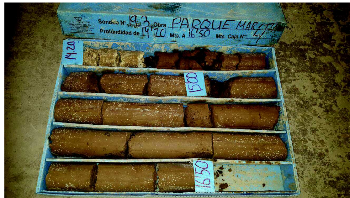
Foto 348: Sondeo 19.3 de 14,20 a 16,50 m
