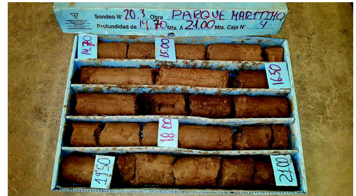
Foto 357: Sondeo 20.3 de 14,70 a 21,00 m
