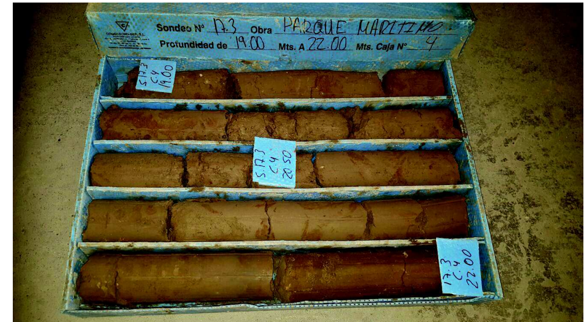
Foto 333: Sondeo 17.3 de 19,00 a 22,00 m
