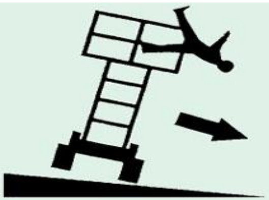
Vuelco del equipo por falta de estabilidad
